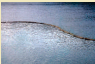
5. Retenção de óleo em água salgada, com direcionamento do fluxo para sucção.
