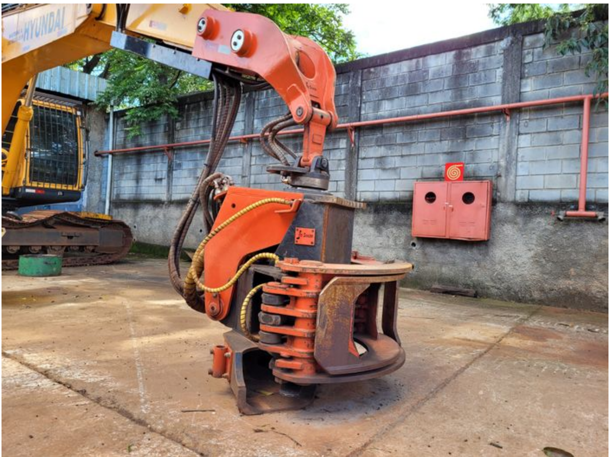
Figura 4 — Cabeçote multifuncional acoplado em escavadeira hidráulica de peso operacional de 26 toneladas.
